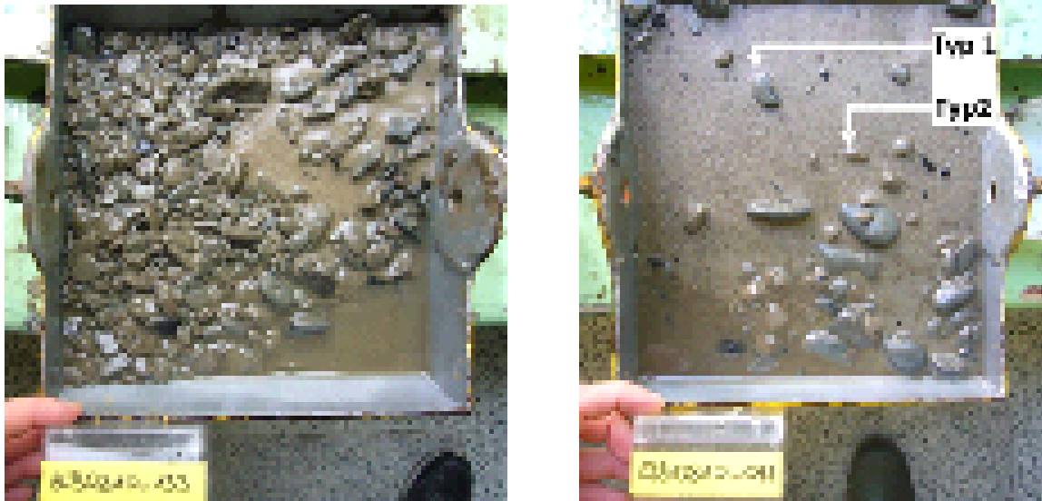
Abbildung 3-1: Fotos von Greiferproben aus dem Elbe-Ästuar. Die feinsandige Matrix ist unterschiedlich dicht von Schlickgeröllen überlagert bzw. durchsetzt. Auf dem Foto rechts wird zudem exemplarisch auf Schlickgerölle verwiesen, die sich insbesondere durch ihre Konsistenz (Typ 1: hart, Typ2: weich) und demnach auch durch ihre Materialherkunft unterscheiden
