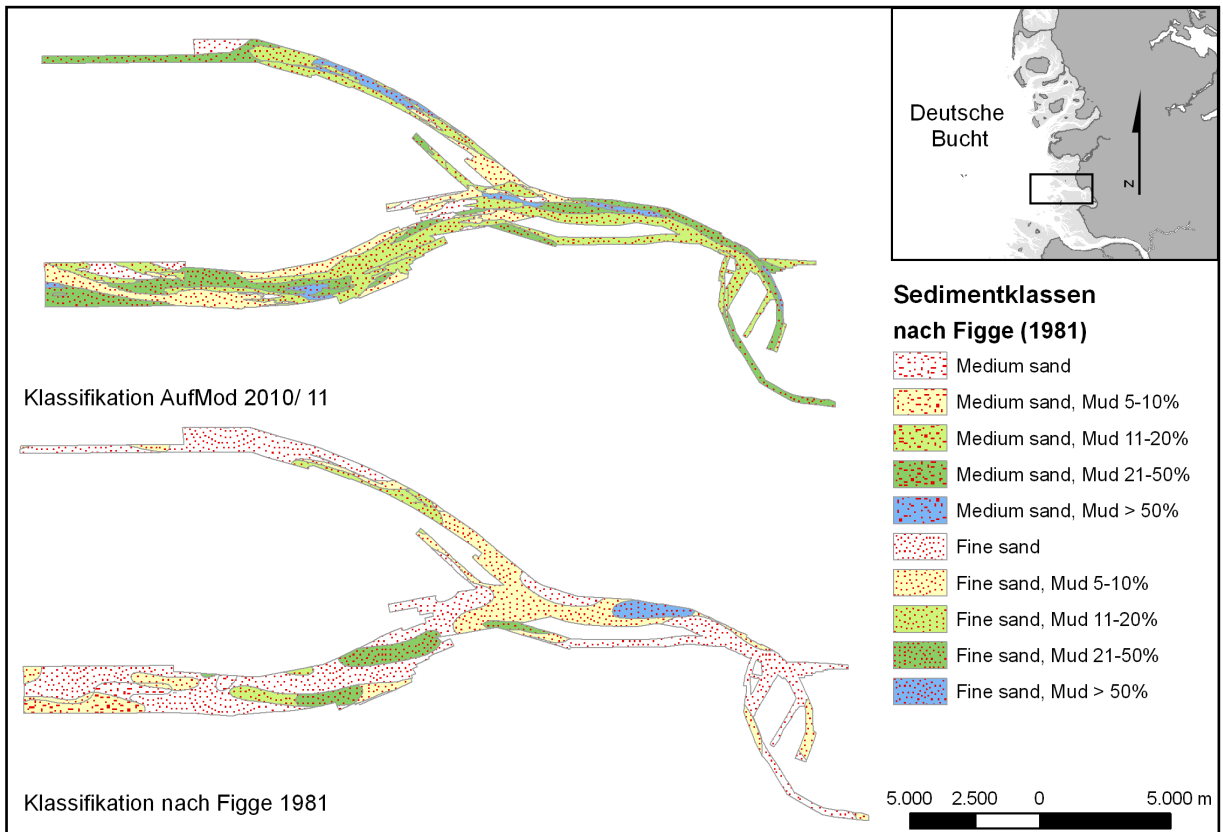
Abbildung 3-48: Vergleich der in AufMod-F für das Gebiet der Pieprinnen entwickelten Sedimentkarte (2010/11) mit der Figge-Karte (Maßstab 1:100.000)
